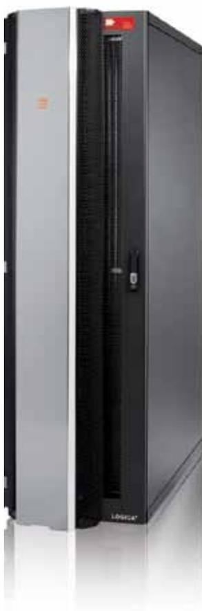
**LRD** Двери с водяным теплообменником являются сердцем системы и устанавливаются сзади стоек. Охлаждение воздуха осуществляется от 50 до 24 °С. Двойной перепад температуры на теплообменнике дает двойную мощность при той же поверхности.
